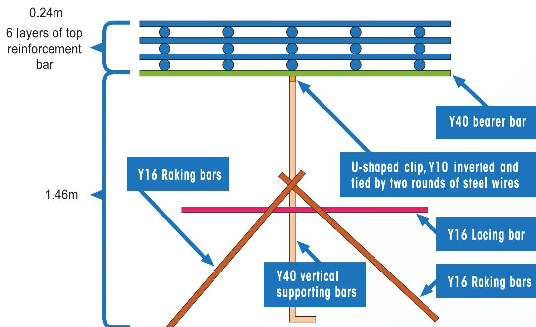
Y40支撐鋼筋的荷載圖示（保護層厚度並不計算在內）
