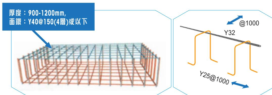
4層150mm間距鋼筋圖示
