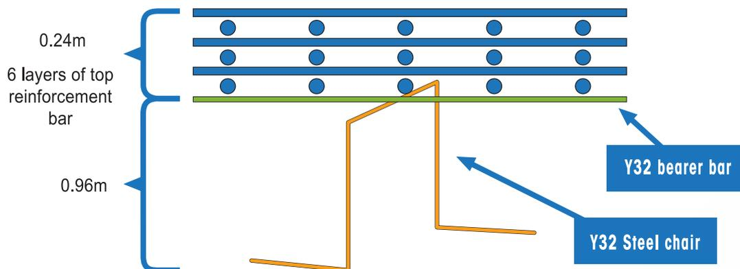
Y32支撐鋼筋的荷載圖示 (保護層厚度並不計算在內)
