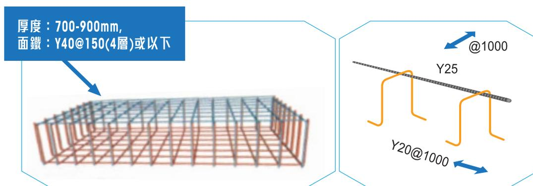
4層150mm間距鋼筋圖示
