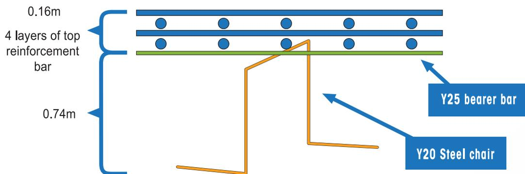
Y20支撐鋼筋的荷載圖示 (保護層厚度並不計算在內)
