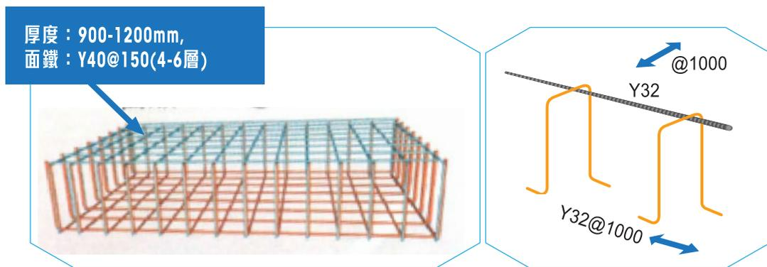
6層150mm間距鋼筋圖示
