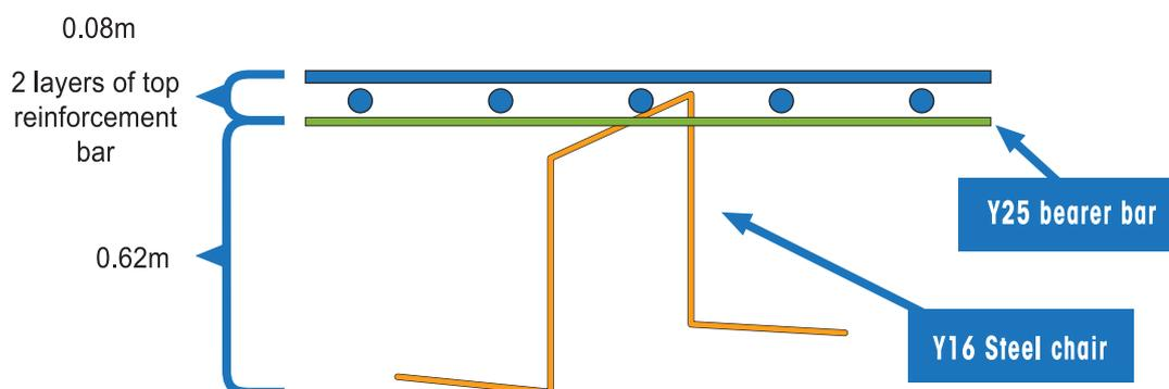
Y16支撐鋼筋的荷載圖示 (保護層厚度並不計算在內)
