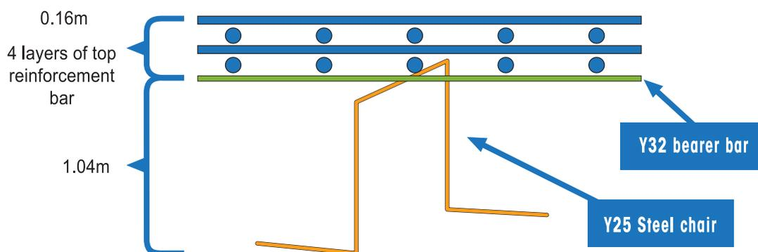
Y25支撐鋼筋的荷載圖示 (保護層厚度並不計算在內)
