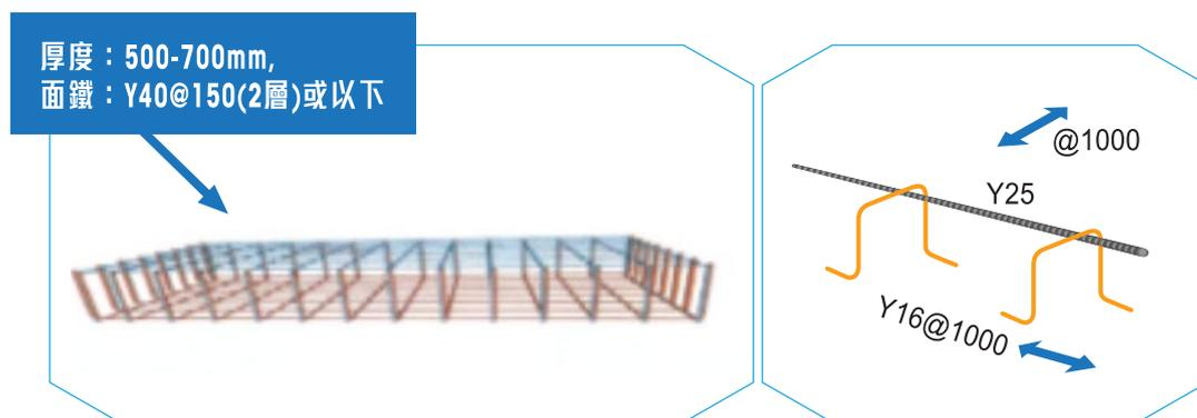
2層150mm間距鋼筋圖示
